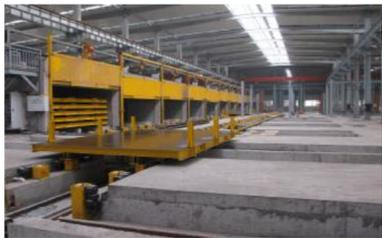
12月1日,杭构·建工建材公司PC生产线迎来首次试生产,试生产的产品为预制装配式检查井的底板和顶板。上午9时,经过设备安装人员对生产线设备的最后调试,伴随着试生产开始的指令,PC生产线试生产正式启动。料斗布料,模台按照预设线路缓缓驶出离模工位,通过横移机构转入1#浇筑工位,在振动平台上完成首次振捣,最后成功回转到1#养护室内,整个过程历时约40分钟。
